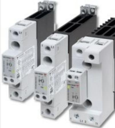
A série RGS fornece ao mercado o SSR mais simples de fase única do seu tipo, com apenas 17,5 mm de largura. A tensão de saída máxima é 600VAC com uma classificação de corrente de 90AAC (com dissipador de calor apropriado). Ambas as versões de controle de CA e CC estão disponíveis cobrindo uma ampla gama de tensões de entrada.
