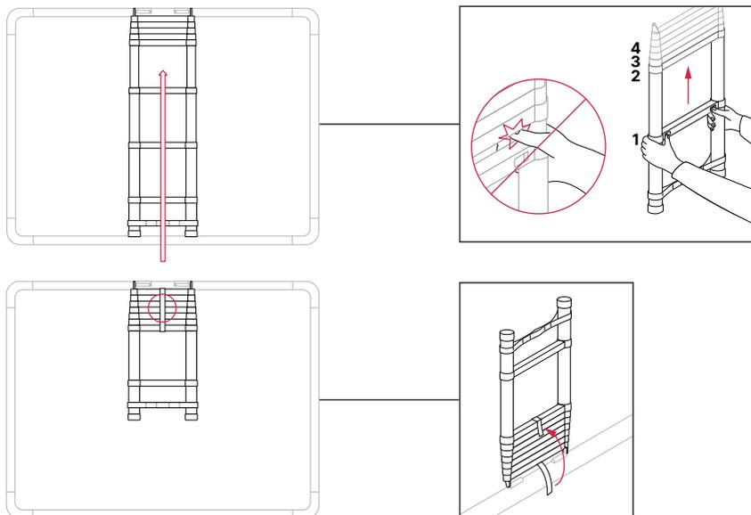
**6** Démontez l'échelle de la tente de toit avant de partir et la ranger dans la tente ou dans la voiture.
