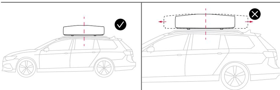
Fais attention aux débordements vers l'avant et vers l'arrière. Si la tente est montée trop en avant, cela influence considérablement les caractéristiques de conduite. Si la tente est montée trop en arrière, l'ouverture du hayon peut éventuellement être influencée. Lors du premier montage, il est indispensable de vérifier le fonctionnement du hayon.
