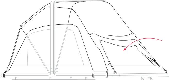
**4** Replier la toile de tente vers l'intérieur. Relever la tente à l'aide de l'échelle. Pour cela, il est préférable de déployer d'abord complètement l'échelle.
