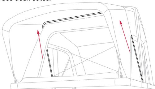
7 Tirer l'arc avant en aluminium **simultanément** des deux côtés jusqu'à ce qu'il y ait un clic.
