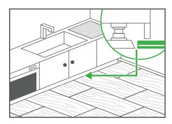
So ist eine einfache und unkomplizierte Wiederaufnahme des Bodens jederzeit möglich. Die Dehnungsfugen werden im Wandbereich mit Sockelleisten, in anderen Bereichen durch spezielle Bodenprofile, abgedeckt. Gegebenenfalls kann es sinnvoll sein, bereits bei der Verlegeplanung die Position schwerer Gegenstände miteinzubeziehen.
