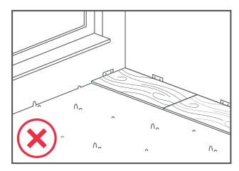
Wir empfehlen, eine Verlegung auf älteren PVC-, CV- und Linoleum-Belägen nur dann durchzuführen, wenn die Böden fest verklebt sind, keine losen Stellen aufweisen und keine Fußbodenheizung vorhanden ist. Eine geeignete Verlegeunterlage muss verlegt werden, um Unebenheiten auszugleichen.
