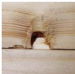
Der bei uns eingesetzte Rauspund verfügt immer über eine gute dicke und eine schlechtere dünne Seite. Eine hohe Astanzahl der Bretter unterstreicht die Natürlichkeit des Holzes und ist keine Qualitätsminderung. Diese Bretter können zusätzlich auf der Unterseite Baumkanten oder teilweise eine fehlende Nut oder Feder haben. Bitte stecken Sie die Bretter nur ineinander und pressen Sie diese nicht zusammen.
