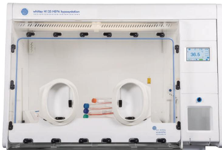
Vous pouvez contrôler l'oxygène par incréments de 0,1 % jusqu'à 20 % ; le dioxyde de carbone par incréments de 0,1 % jusqu'à 15 % ; et l'humidité relative jusqu'à 80 %. Cela offre une grande flexibilité dans vos recherches et une grande confiance dans vos résultats.
