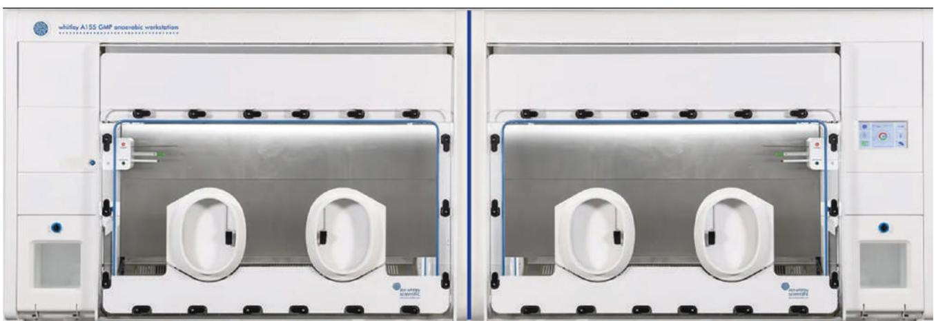
Chaque poste de travail est testé par un organisme indépendant afin de garantir sa conformité à la norme ISO 14644-3. En outre, les tests effectués dans nos propres laboratoires confirment que le système de flux laminaire intégré avec filtre HEPA répond aux exigences de la norme BS EN 12469:2000 en matière de protection de la zone de travail contre la contamination particulaire et microbienne.
