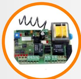
Placa microprocesada BAS V4 SMD con manejo de apertura y cierre a un pulso. Cierre temporizado, embrague anti-aplastamiento, ralentización optativa y salida para fotoeléctrica.
