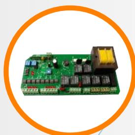
Placa microprocesada 2M con manejo de apertura y cierre a un pulso. Cierre temporizado, embrague anti-aplastamiento, ralentización optativa y salida para electrocerradura y fotoeléctrica. Permite programar el paso peatonal en caso de portones de dos hojas.
