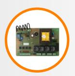
Placa microprocesada F1M V4 SMD con manejo de apertura y cierre a un pulso. Cierre temporizado, embrague antiaplastamiento, ralentización optativa, salida para fotoeléctrica y electrocerradura.
