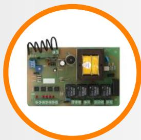
Placa microprocesada F1M V4 SMD con manejo de apertura y cierre a un pulso. Cierre temporizado, embrague antiplastamiento, ralentización optativa, salida para fotoeléctrica y electrocerradura.
