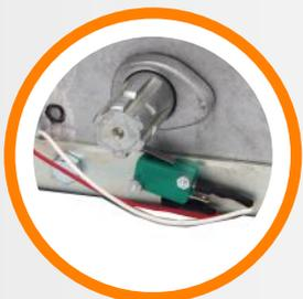
Los finales de carrera aplicados a la salida del eje de transmisión otorgan una parada precisa y alargan la vida útil del motorreductor.
