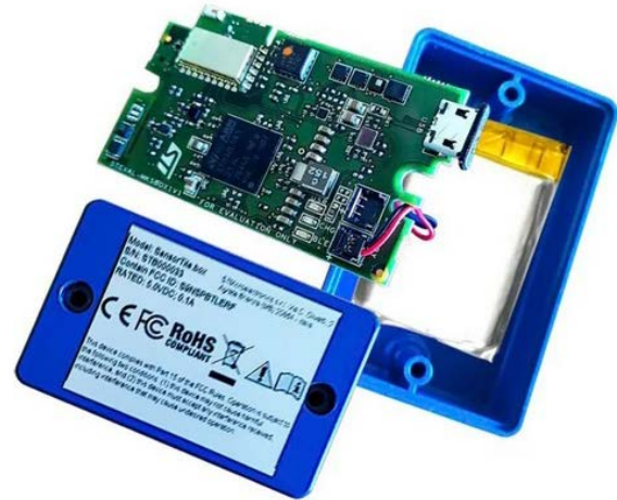
Bild 12. Neben vielen anderen Funktionen kann mit dem STEVAL-MKSBOX1V1 von STMicroelectronics ein Schrittzähler realisiert werden (Bild: RS Components)
