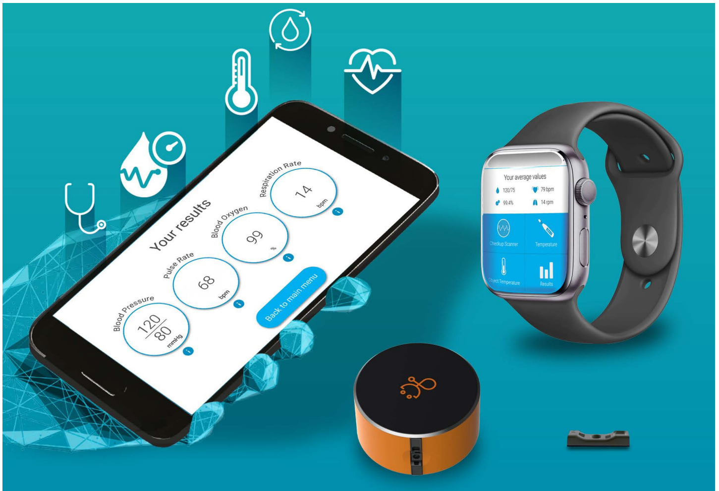
Bild 4. Ein eigenständiges V-Sensor-Miniaturgerät von Leman Micro Devices sendet die Messergebnisse via Bluetooth an ein Smartphone. Dort zeigt die e-Checkup-App die Ergebnisse der Blutdruckmessung. (Bild: Pressebild Leman Micro Devices)
