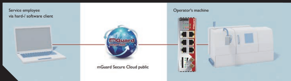
mGuard Secure Cloudを使用するとIPsecセキュリティプロトコルによる暗号化を使用してスケーラブルなVPNインフラをセットアップできます。これにより交換される全てのデータの機密性、信頼性、完全性が保護されます。マシンと生産ネットワーク間の安全な接続のためにFL mGuardセキュリティ機器は更にマシンネットワークを不正アクセスから保護する広範なファイアウォール機能を提供します(図4)。
