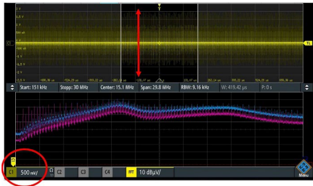
Abbildung 3: Die vertikale Auflösung bzw. Skala des Kanals wird optimal genutzt, somit erhält man die höchste Empfindlichkeit.
