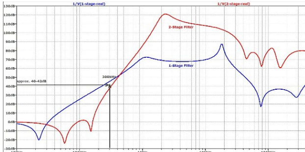
Abbildung 18: LTspice Simulation der DM Einfügedämpfung, 10 kHz bis 400 MHz; Blau = 1-Stufen-Filter; Rot = 2-Stufen-Filter
