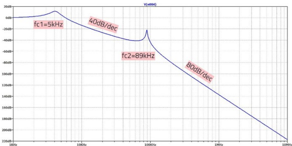
Abbildung 48: Dämpfungsverhalten eines 2-Stufen-Filters
