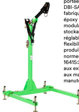
Le système de potence à courte portée HC (haute capacité) 3M™ DBI-SALA® pour espace confiné est fabriqué en aluminium enduit de époxy et dispose d'une conception modulaire pour un transport et un stockage aisés. Notre système est réglable, ce qui permet une certaine flexibilité lors de l'installation. Ce produit est certifié conforme aux normes EN795:2012, CEN/TS 16415:2013, EN1496:2012, et répond aux exigences de la directive relative aux machines 2006/42EC pour la manutention des matériaux.
