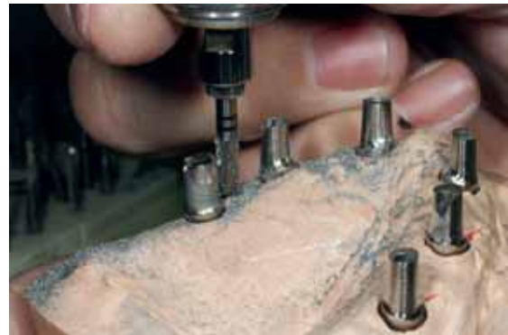
Abb. 14: Die mit den Titanklebebasen verklebten Primärteile werden gefräst und poliert. Für einen sicheren Halt der Sekundärteile besitzen sie eine mindestens fünf Millimeter hohe vertikale Funktionsfläche.
