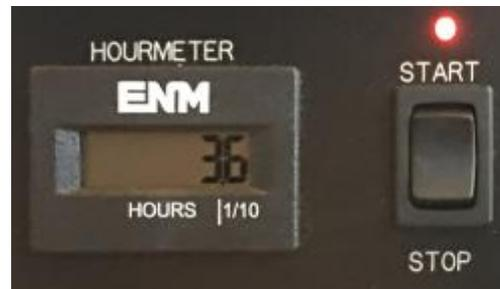
Der Generatorenölstand muss alle acht (8) Betriebsstunden kontrolliert werden
