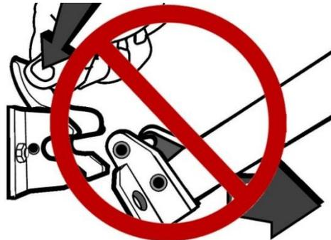
**Lösen Sie die Arme der Markise NIE von den Halterungen an der Aussenwand!**
