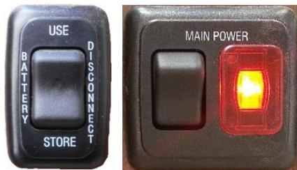
Alle Wohnmobile haben einen Schalter nahe der Einstiegstüre um die Zusatzbatterie auszuschalten. Lassen Sie diesen Schalter in der EIN (ON oder USE) Stellung um die Funktion aller elektrischen Geräte sicherzustellen. Sollte der Schalter AUS (OFF oder STORE) sein, funktioniert nichts mehr im Wohnmobil und die Zusatzbatterie werden NICHT geladen, selbst wenn Sie Stromanschluss am Campingplatz haben oder den Generator betreiben.
