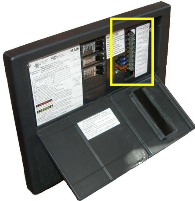
Jedes Wohnmobil hat einen Sicherungskasten, welcher sich im Schlaf- oder Wohnzimmer befindet. Er enthält eine Reihe von Sicherungen (Standard 12 Volt Automobilsicherung). Falls ein elektrisches Gerät nicht mehr funktioniert, prüfen Sie erst die Sicherungen. In einer kaputten Sicherung ist der kleine Faden gebrochen.
