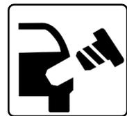
Falls sich die Benzindeckelleuchte einschaltet, sollte der Benzindeckel entfernt und erneut festgemacht werden. Eine Weiterfahrt ist problemlos möglich. Der Computer wird einige Tage benötigen, bevor er die Leuchte löscht.
