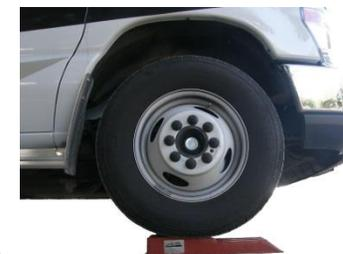
**ACHTUNG:** Maximale Seitenschiefelage von 3° und Kippschiefelage von 6° (von vor dem Kühlschrank aus gesehen). Betrieb bei grösseren Schiefelagen kann das Kühlsystem beschädigen und ein Verletzungs- und Schadensrisiko entstehen.
