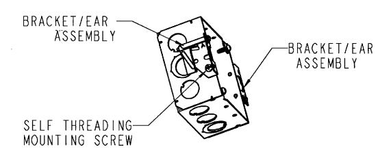
TYPICAL INSTALLATION ON WELDED ON SIDE OF METALLIC BOX
