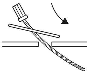
Insérer à travers la cavité. Assurez-vous que la bascule et la butée se trouvent dans la cavité
