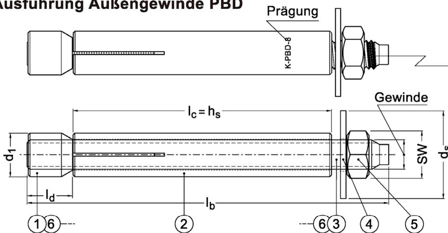
Zur Kennzeichnung der unterschiedlichen Lastklasse für Dübeltyp PBD M 8/14 roter Montagerring
