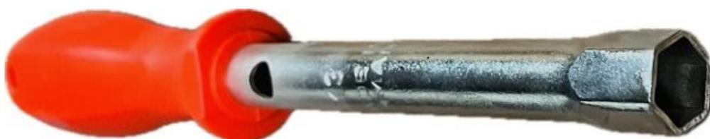
Clé à douille tubulaire avec manche en plastique. Tube en acier étiré à froid sans soudure, matériau : 25Cr/Mo4, trempé jusqu'à une résistance de 110-150 Kg/mm<sup>2</sup>. Manche en plastique résistant aux chocs.
