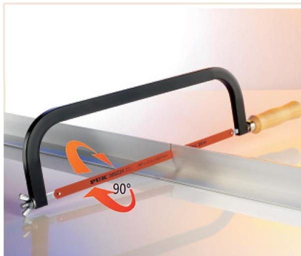
Monture de scie classique tout métal selon DIN 6473, revêtement par poudre, noir avec manche en hêtre rouge. Construction particulièrement robuste avec goupilles imperdables, écrou papillon de haute qualité et lame de scie bimétal PUK serrée 300 mm, 24 dents / pouce.
