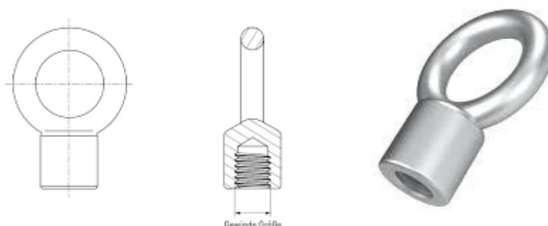
Les crochets de suspension sont conçus pour **des charges plus élevées**, par exemple pour fixer de manière permanente des composants suspendus ou des armoires de commande lourdes ou pour assurer la sécurité du transport..
