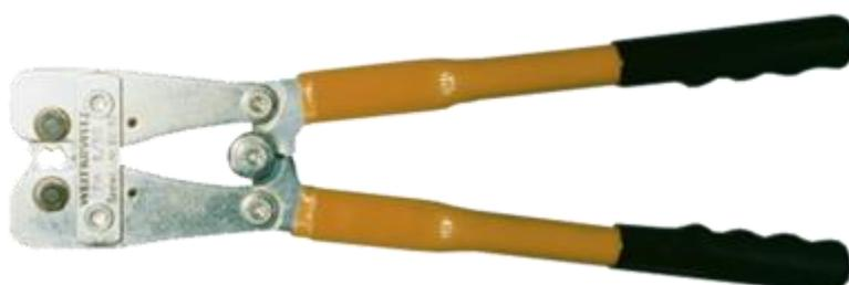
Pince à sertir pour le sertissage des souliers de câbles DIN 46235, des connecteurs DIN 46267, des souliers de câbles en aluminium et des connecteurs en aluminium. La section transversale est réglée en tournant les disques profilés intégrés. Le remplacement des inserts de presse n'est pas nécessaire. Les dimensions réduites, le faible poids et la haute qualité de sertissage grâce au pressage hexagonal et au poinçonnage de contrôle sont particulièrement remarquables.
