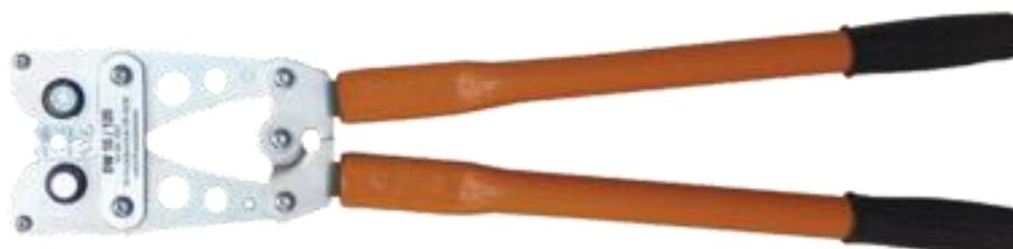
Pince à sertir pour le sertissage des souliers câbles à compression DIN 46235, des connecteurs DIN 46267, des souliers de câbles en aluminium et des connecteurs en aluminium. La section transversale est réglée en tournant les paliers intégrés. Le remplacement des inserts de presse n'est pas nécessaire.
