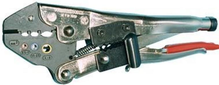
Pince à sertir avec verrouillage de fin de course pour le traitement de cosses de câbles à sertir isolées, de connecteurs, de fiches plates, de manchons plats, de fiches circulaires et de manchons circulaires de 0,5 à 6 mm<sup>2</sup>. Un dispositif de coupe et de dénudage pour câbles jusqu'à 6 mm<sup>2</sup> est disponible.
