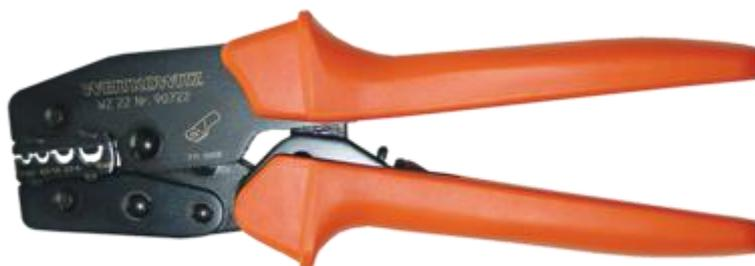
Pince à sertir pour le traitement des cosses et connecteurs tubulaires de la série standard de 0,5 à 10 mm<sup>2</sup>. Le verrouillage forcé garantit une qualité de pressage constamment élevée. La transmission à levier à bascule permet d'obtenir un angle d'ouverture favorable et moins de force est nécessaire lors de la pression.
