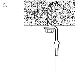
Visser le boulon, ou tirer à l'aide d'un cloueur dans la cavité en maintenant la position
