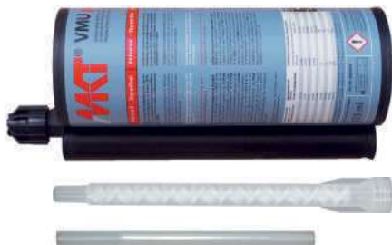
Patroon VMU plus 825 Side-by-side Patroon Inhoud: 825ml Met grote mengtuit VM-XL en reduceer-/ verlengingsbuisje voor boorgaten vanaf 12 mm diameter
