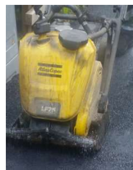
Packning med vält eller vibroplatta för större ytor
