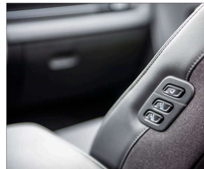
Enkel justering av baksetet. Her styrer en setet elektrisk bakover om man vil ha mer benplass til passasjerene, eller fremover for mer bagasjeplass.
