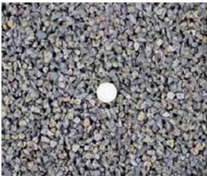
Offenporige Asphalte verringern den Lärm von Pkw und Lkw
