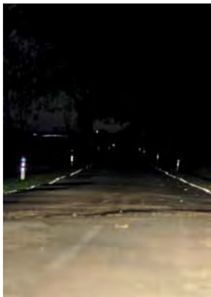
Schlechte Erkennbarkeit der Linienführung bei Nacht wegen mangelhafter Fahrbahnmarkierungen
