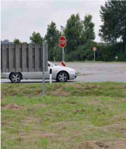
Sichtschutz zwingt Verkehrsteilnehmer zu langsamer Annäherung an die Haltelinie
