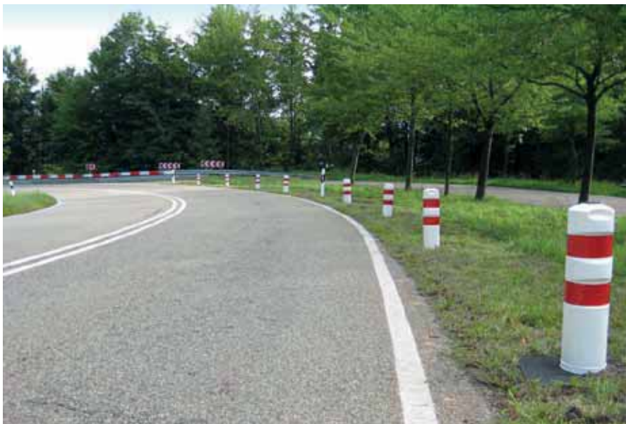
Sicherheit für Motorradfahrer: Nachgiebige Poller und Kippstangen aus Kunststoff zur Verdeutlichung von Kurven
