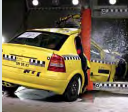
Crash-Test, Seitenaufprall bei 40 km/h
