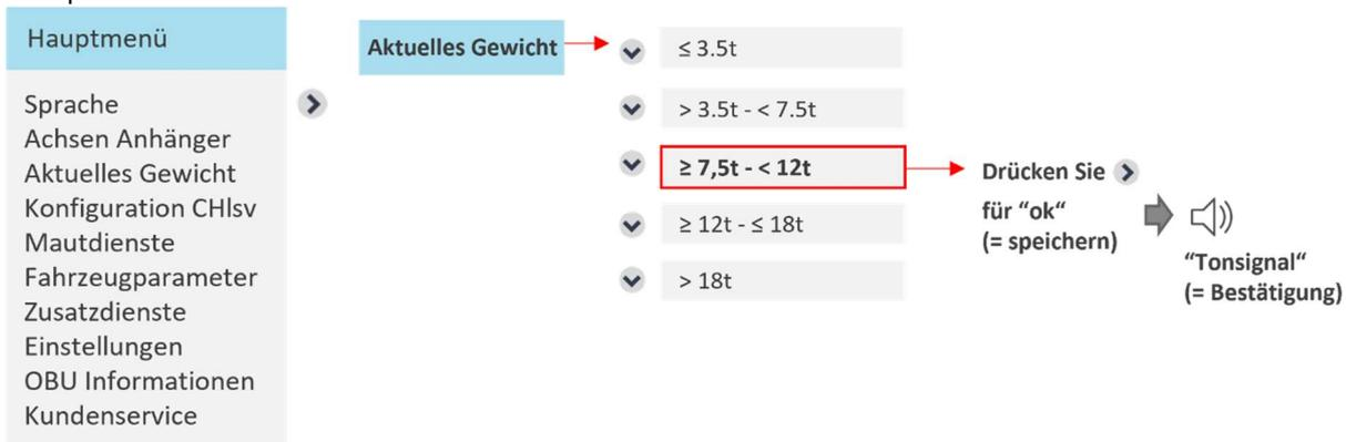
Hier ist das Gewicht wegen eines Anhängerwechsels von kleiner als 7,5 t auf 7,5 t bis 12 t geändert. Nach dem Aktualisieren des Wertes, drücken Sie kurz die rechte Taste **➤** für "ok". Verlassen Sie das Menü durch zweimaliges Drücken der Links Taste **◀◀**
