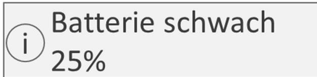
Wenn die Batterieladung unter 25 % fällt, erzeugt die OBU ein Tonsignal und zeigt eine Warnmeldung. Der Nutzer gelangt durch Bestätigung zurück zum normalen Bildschirm. Wenn die Batterieladung unter 10 % fällt, erzeugt die OBU ein Tonsignal und zeigt eine Warnmeldung. Der Nutzer gelangt durch Bestätigung zurück zum normalen Bildschirm.
