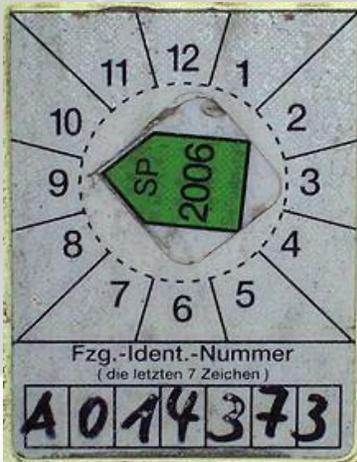
Die **Sicherheitsprüfung (SP)** ist eine Sicht-, Wirkungs- und Funktionsprüfung bei Nutzkraftwagen (Nkw) in Deutschland.
