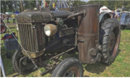
*In Ermangelung von Flüssigkraftstoffen kamen in der Zeit des Zweiten Weltkriegs häufig Traktoren aber auch Pkw und Lkw mit Holzgas-Generatoren zum Einsatz.*
