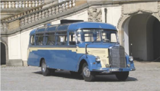
Mercedes-Benz O3500 aus der Oldtimerbus-Flotte von Dr.-Ing. E. h. Konrad Auwärter. Im Rahmen der Veranstaltung „120 Jahre Mythos Solitude“ wurde der Bus testweise mit dem Kraftstoff HVO100 betankt und seither wird der Bus ausschließlich mit diesem synthetischen Sprit betrieben. Die bisherigen Erfahrungen mit diesem Sprit sind sehr positiv.
