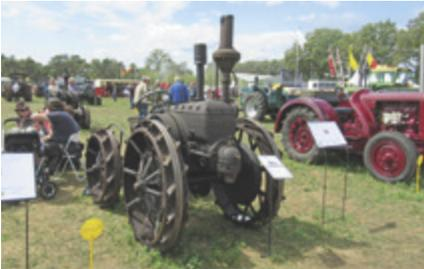
*Lanz „Knicklenker-Bulldog“, Baujahr 1923, mit 6,2-Liter-Einzylinder-Glühkopf-Motor und Allradantrieb.*
