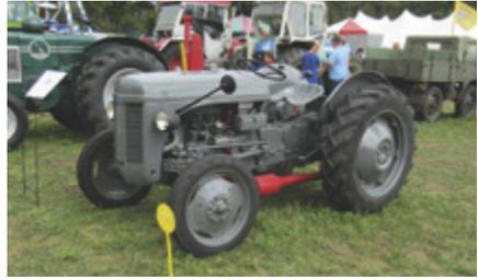
*Mit der Dreipunkt-Regelhydraulik entwickelte Harry Ferguson ein System zur Befestigung und Steuerung von Arbeitsgeräten, das bis heute an fast jedem Traktor verwendet wird.*
