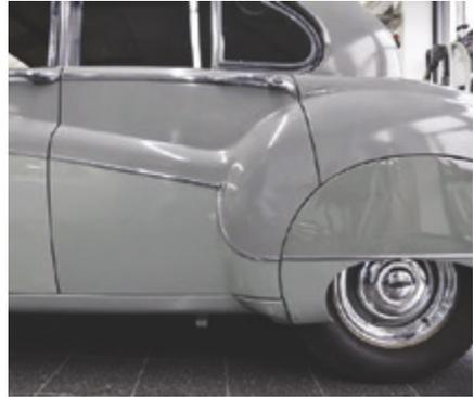
*Fahrzeug in Zweifarbenlackierung. Der Jaguar MK 9 war das Messefahrzeug von Glasurit bei der Techno-Classica 2018. Insgesamt weisen die einzelnen Fahrzeugteile jedoch etwa 20 unterschiedliche Nuancen/Varianten auf. Dokumentiert war, wie so oft, fast nichts zu den bisherigen Lackierarbeiten.*
