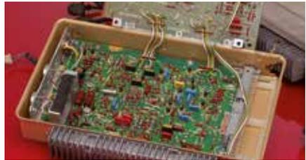
(ECU – Electronic Control Unit), von denen eine Handvoll bis hin zu 100 Einheiten pro Fahrzeug integriert sind.
