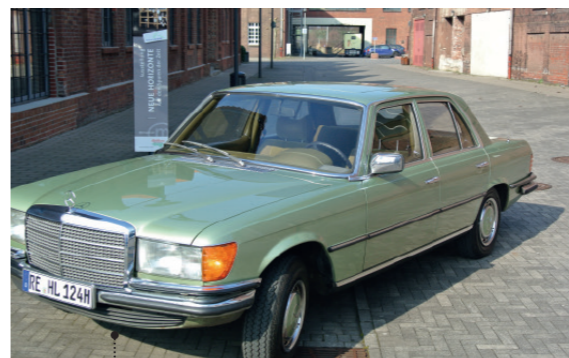
o Johannes Michael Lackmann und Josef Wiemann Mercedes-Benz 280 S (W 116) 93 2746 ccm | 156 PS | 1978
