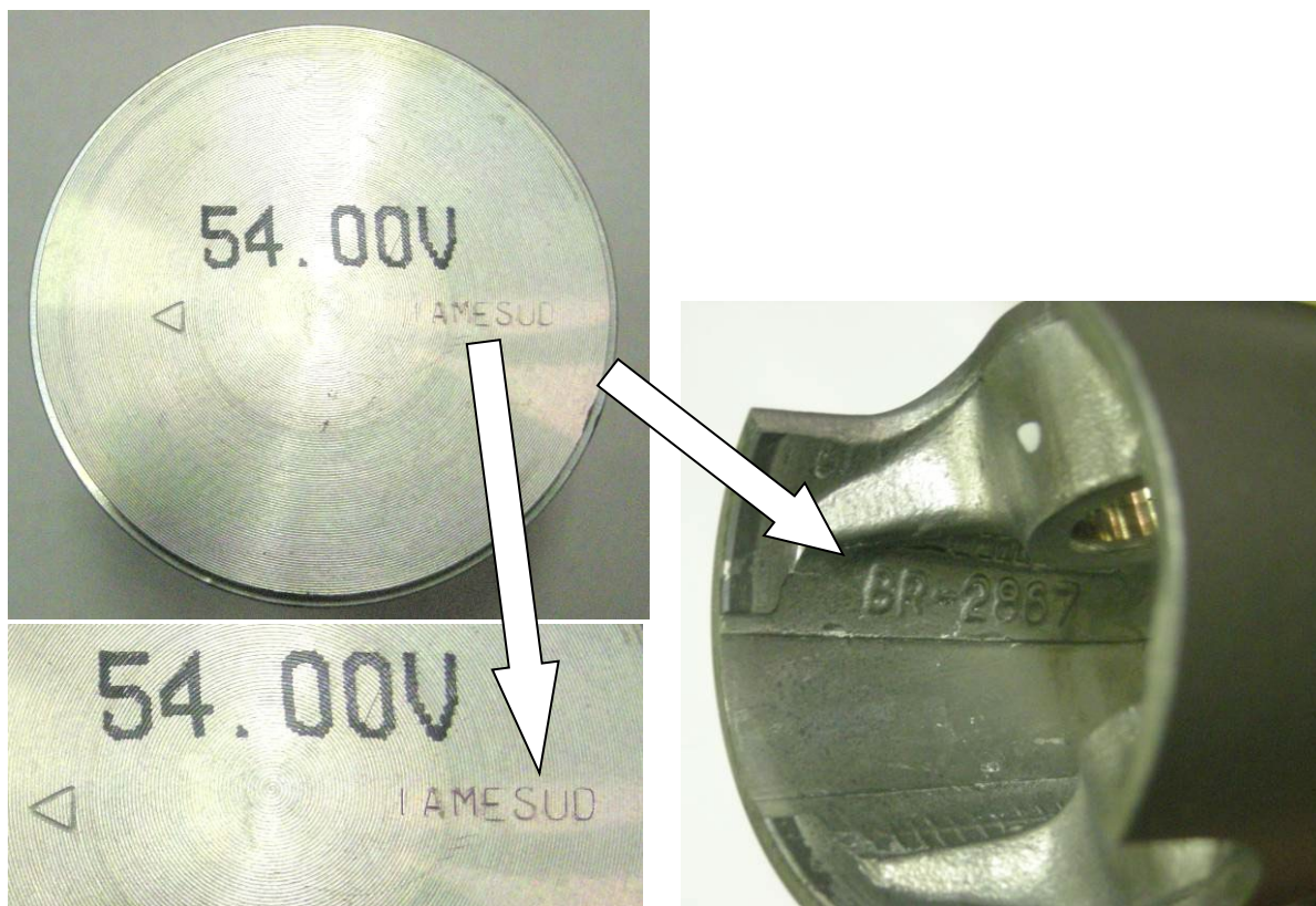
IDENTIFICATION BALANCING SHAFT MARKING MARQUAGE D'IDENTIFICATION ARBRE D'EQUILIBRAGE
