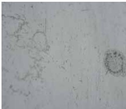
*Lackierung eines Porsche 911 aus dem Südwesten der USA. Die Oberflächenschäden können mit schwarzem Kontrollpulver sehr gut sichtbar gemacht werden. Der Lack ist teilweise rissig und durch Sonneneinstrahlung und Säure zerstört, möglicherweise auch durch Insekten und/oder Vogelkot.*
