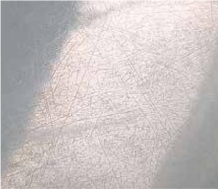
*Panhard: Rissiger Lack an einem Panhard Dyna X Baujahr 1949 – vermutlich die Erstlackierung. Die Schutzwirkung der Lackierung ist noch immer gegeben. Der kulturelle Aspekt genießt Vorrang vor der Notwendigkeit zur Reparatur dieser Oberfläche. Bei sachgemäßer Lagerung oder Konservierung kann dieses Fahrzeug noch eine lange Zeit überdauern.*
