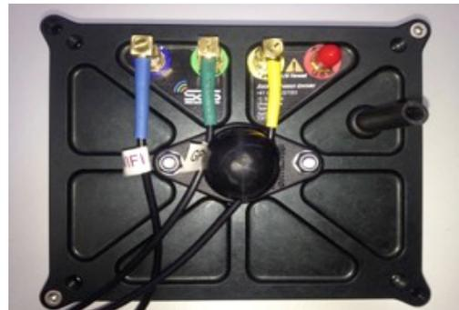
Mindestens 300 mm des RallySafe Power Kabelbaums und des Antennenkabels sollten nahe der RallySafe-Einheit zur Verfügung stehen, um ein einfaches Anschließen zu gewährleisten.
