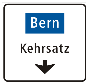
4.42 Einspurtafel über Fahrstreifen auf Nebenstrassen (Art. 53)
