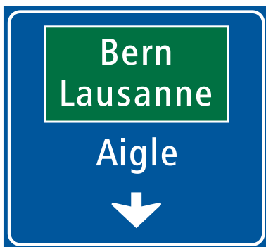
4.41 Einspurtafel über Fahrstreifen auf Hauptstrassen (Art. 53)
