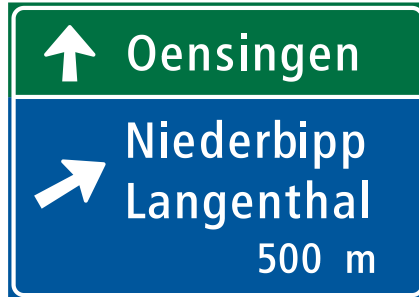
4.61 Vorwegweiser bei Anschlüssen (Art. 86)
