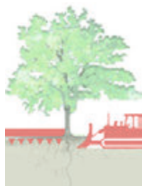
Scavo/riporto (in casi di estrema necessità, l'esecuzione dovrà essere effettuata manualmente)
