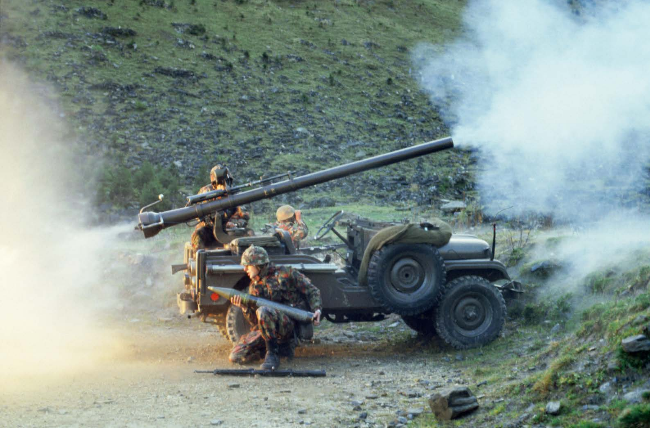
Die rückstossfreie Panzerabwehrkanone rsf 10,6cm Pak 58 konnte ab Fahrzeug oder von der Lafette ab Boden abgefeuert werden.
