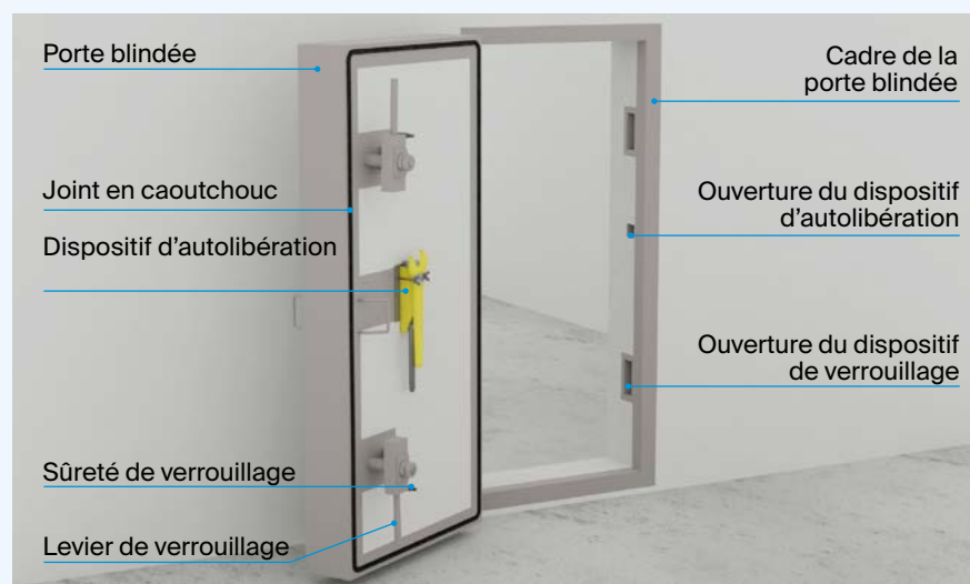
Fig. 4a/4b Lors de la préparation de l'abri, il faut s'assurer que tous les éléments sont présents et en état de fonctionner. La porte blindée permet l'accès, mais doit aussi garantir la protection nécessaire. La porte normale doit être retirée pour l'occupation de l'abri.
