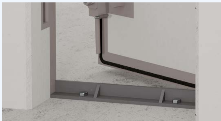
Fig. 5a/5b Pour une meilleure accessibilité au quotidien, certains abris ont été créés sans seuil. Ils disposent d'un seuil démontable, fixé par exemple à la porte blindée, qui est vissé au sol lors de la préparation.
