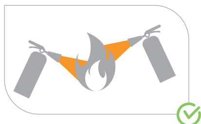
Fig. 31: Impiegare più estintori contemporaneamente, e non uno alla volta
