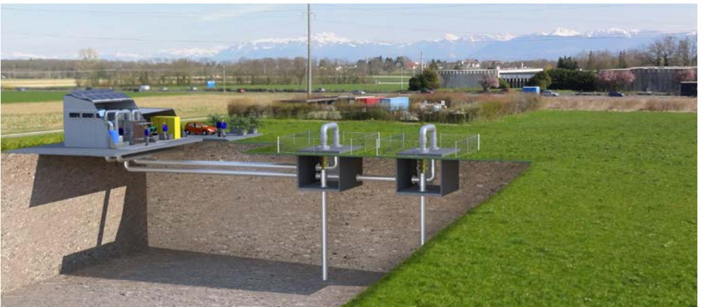
Centrale geotermica di media profondità Energieô a Vinzel (VD), con pozzi di produzione e reiniezione – immagine schematica. Fonte: Energieô
