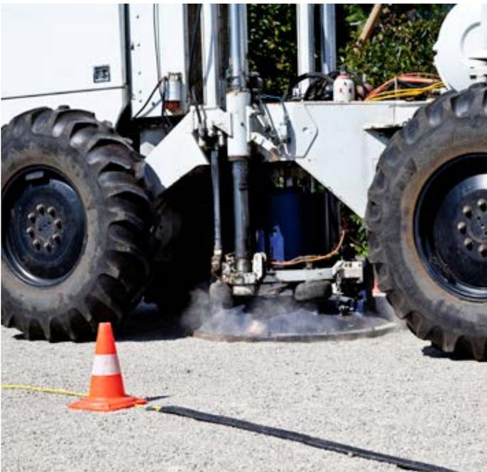
Durante una campagna di esplorazione geofisica, un camion vibrante emette delle onde acustiche che permettono, grazie ai dati raccolti, di realizzare una sezione geologica del sottosuolo. Fonte: Pedro Neto
