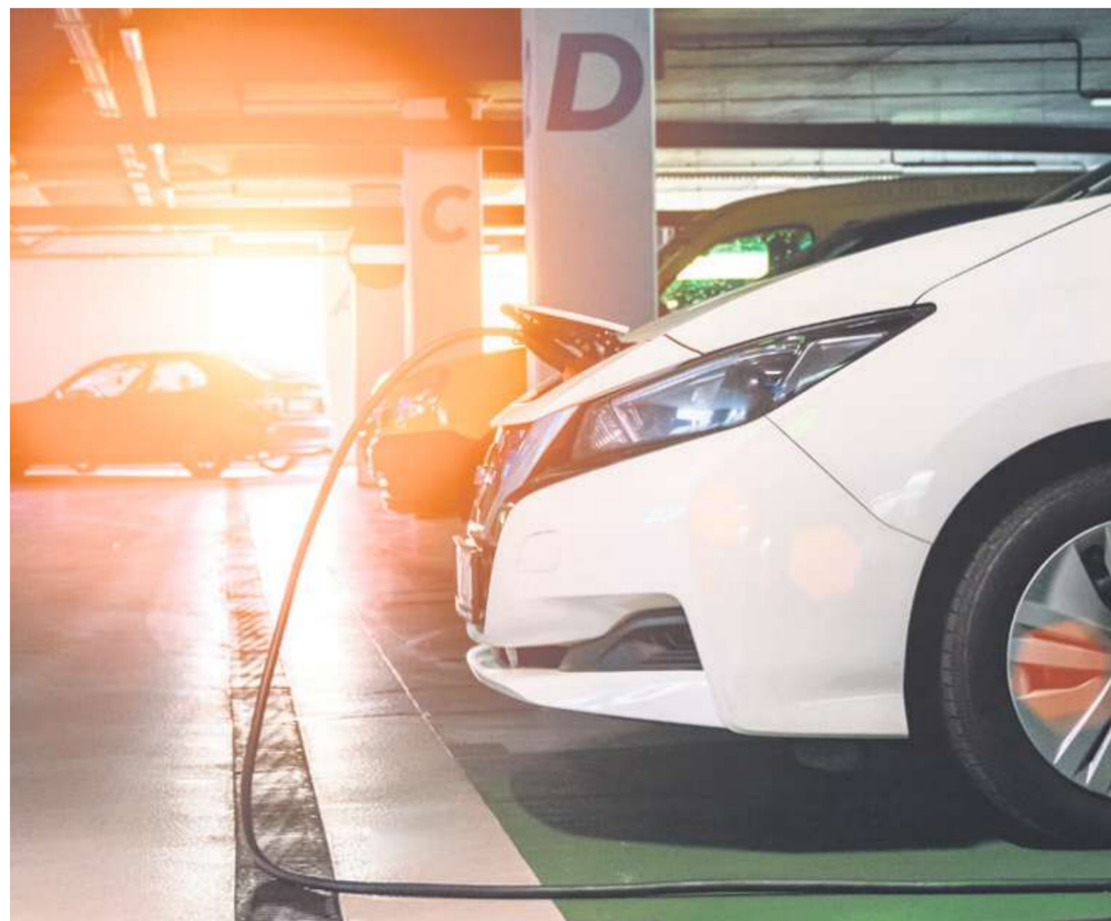
Das Elektroauto als Batterie fürs Haus: Bidirektionales Laden macht es möglich, dass E-Autos nicht nur Strom laden, sondern auch abgeben können. Das Schweizer Start-up-Unternehmen sun2wheel zählt zu den Pionieren dieser Technologie.
