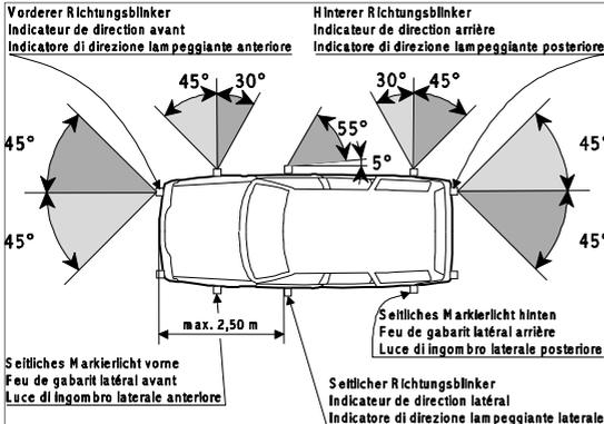
Valable seulement pour les véhicules d'une longueur maximale de 6 m. Distance entre les clignoteurs latéraux et la limite frontale du véhicule: 2,50 m au plus. La plage éclairante des feux de gabarit latéraux clignotant simultanément doit être de 12,5 cm<sup>2</sup> au minimum pour chacun d'eux.
