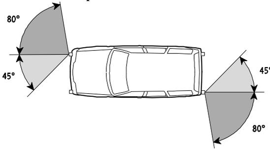
Pour les véhicules des catégories  $M_1$  et  $N_1$ , les angles de visibilité horizontaux peuvent être réduits à  $45^\circ$  vers l'extérieur, lorsque des feux de gabarit latéraux supplémentaires ayant chacun une plage éclairante d'au moins  $12,5 \text{ cm}^2$  sont montés à l'avant ou à l'arrière. Pour les remorques, l'angle de visibilité vers l'intérieur doit être d'au moins  $5^\circ$ .
