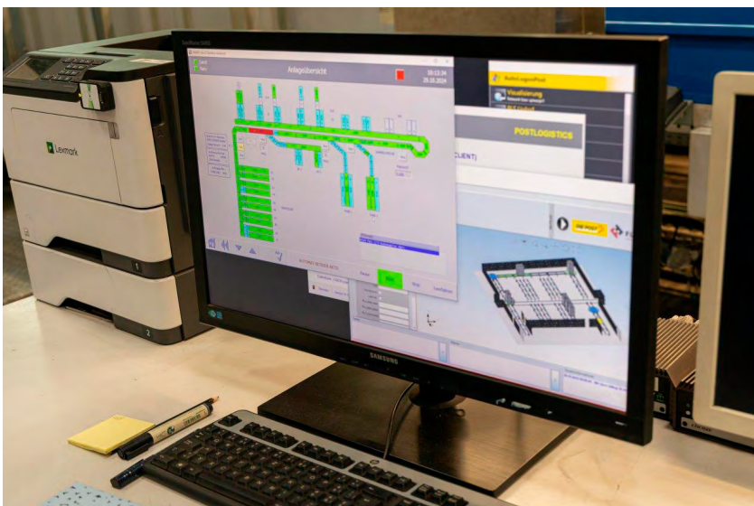
Figure 16 : L'installation de mesure détecte le colis test radioactif et la section concernée (en rouge) du tapis roulant s'arrête
