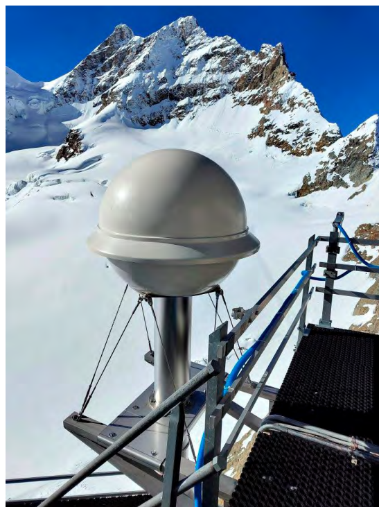
Figure 24: La tête d'aspiration munie d'un chauffage pour la collecte des aérosols
