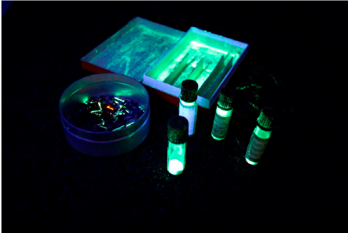
Figure 20 : Kit de posage de peinture au radium découvert lors d'un diagnostic chez un horloger
