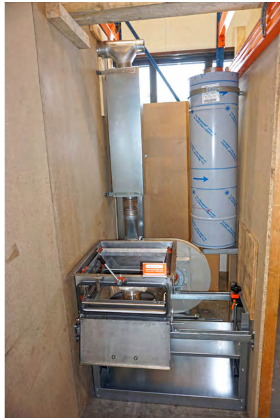
Abb. 28: Die Maschine im Aufbau, im Vordergrund der Sammelbehälter, im Hintergrund die mit Lärmdämpfern ausgestatteten Kanäle für die Luftzufuhr und -abfuhr sowie die Pumpe.
